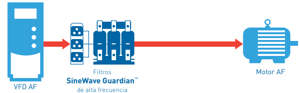
Conductor extremadamente largo hacia el motor
